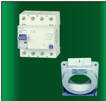
Для защиты от токов утечки на землю в одно- и трёхфазных электроустановках с током нагрузки свыше 125 А необходимо применять специальные УЗО с выносным дифференциальным трансформатором тока.
